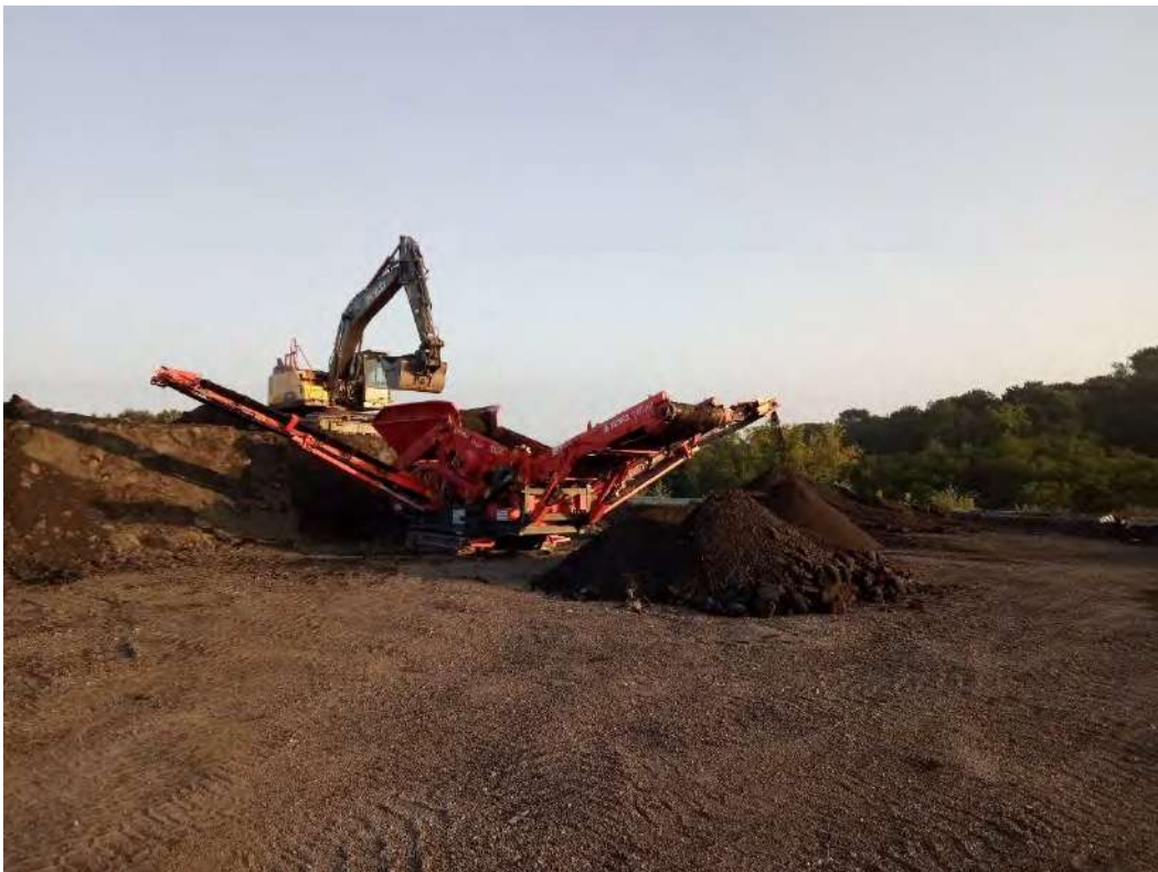
Figure 10 : Photographie d'une installation de criblage de type TEREX FINLAY 883
